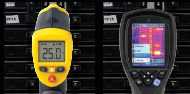
Pirometro: misurazione della temperatura in un singolo punto
