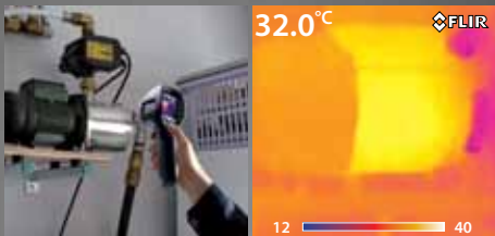
Una termocamera ad infrarossi ti permette di identificare velocemente problemi elettrici e meccanici.
