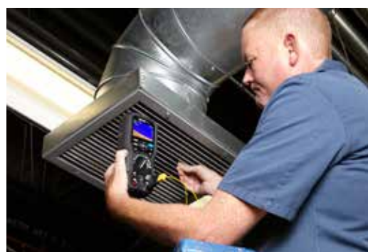
Ingresso a termocoppia di tipo K per misurazioni di temperatura differenziale
